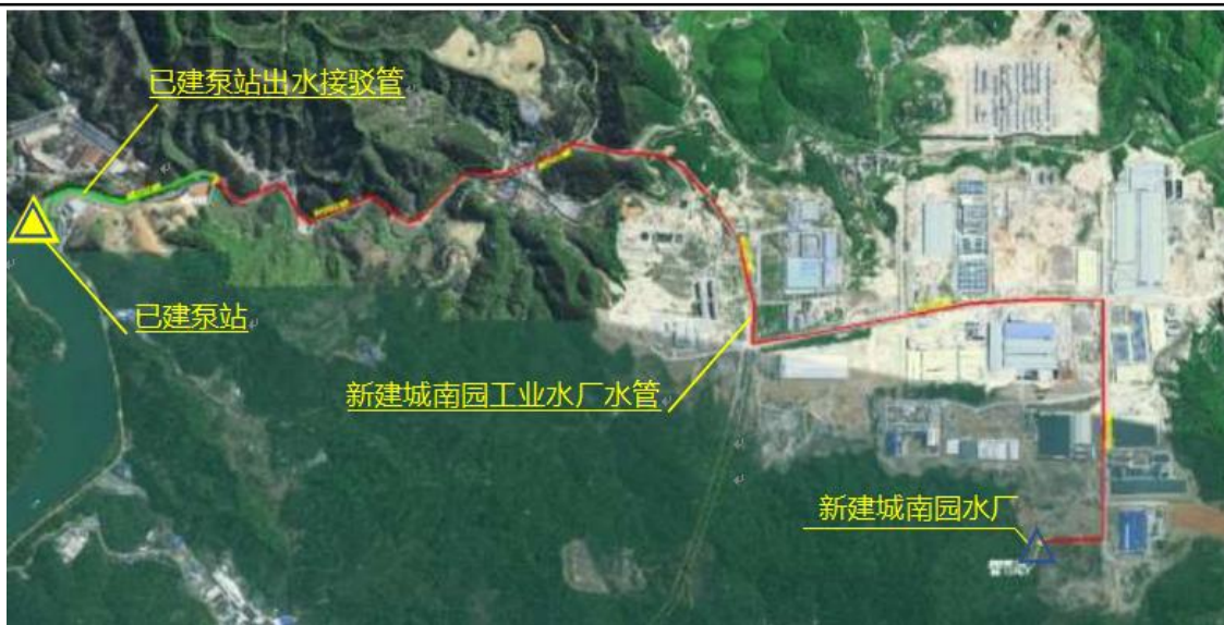
图 2.3-1 城南园工业水厂输水方案示意图
