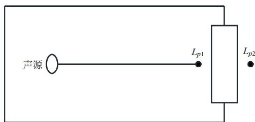
图 4-4 室内声源等效为室外声源图例
