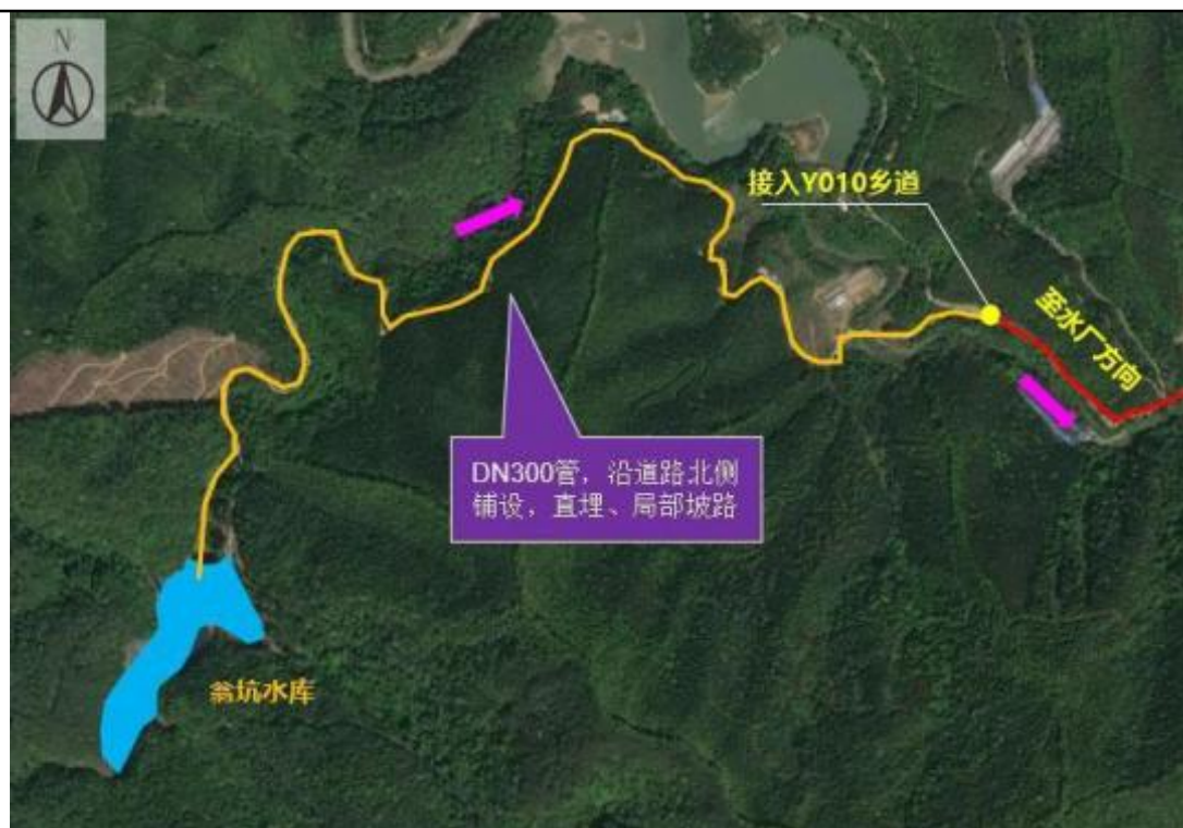
图 2.2-2 瓮坑水库~Y010 乡道接入点段输水管道布置图
