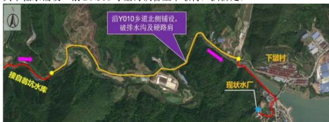
图 2.2-3 Y010 乡道接入点段~下墩村口段输水管道布置图
