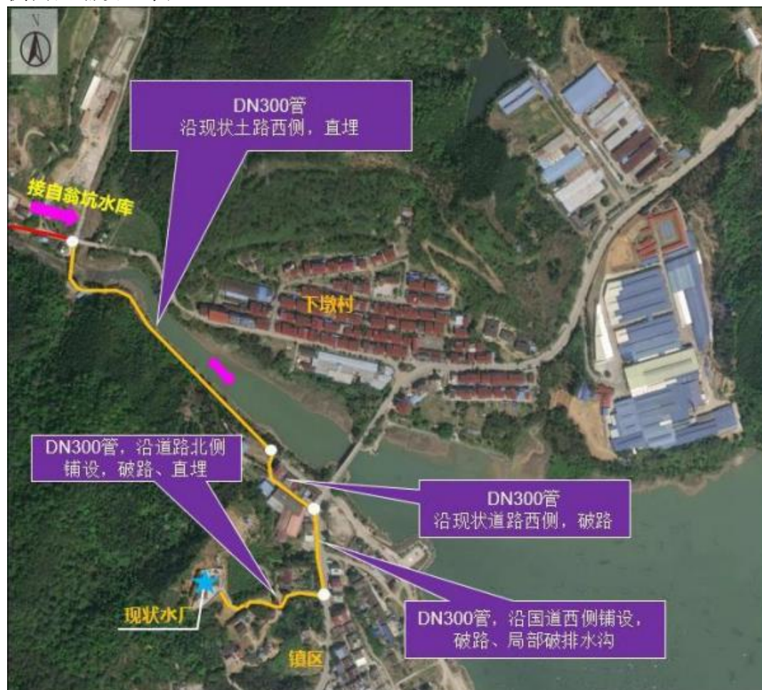
图 2.2-4 下墩村~水厂段输水管道布置图
